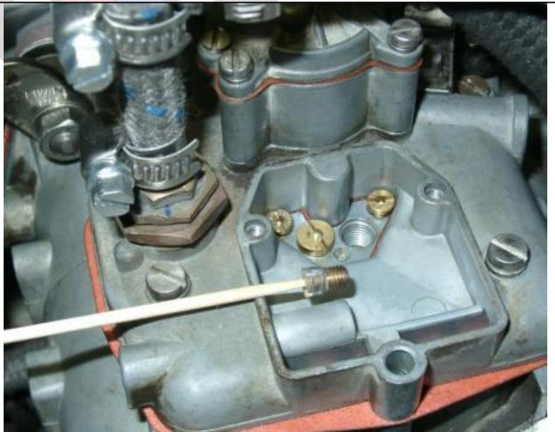
Zur Prüfung der Beschleunigerpumpe versorgt man den Vergaser am besten aus einem Messkolben, öffnet die Drosselklappe zehnmal zügig und liest die verbrauchte Menge am Messglas ab (durch 10
